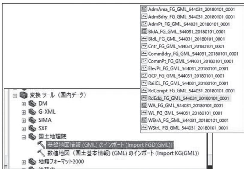
図 18 国土地理院基盤地図情報のインポートと変換されたレイヤーの様子
